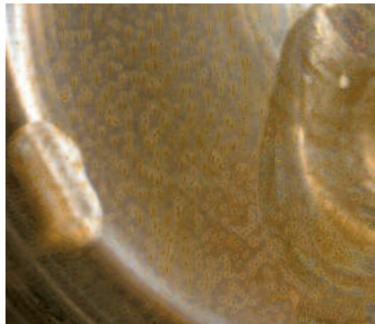
Unterschiedliche Oberflächendefekte mit Korrosion durch Chloridionen
