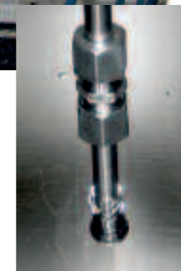
Rechts: Für die Reinigung von Behältern und Kesseln verwendet man hydrodynamisch gelagerte Reinigungsdüsen des Spezialanbieters Aqua Duna
