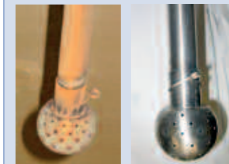
Edelstahloberfläche mit intensivem Rougingbelag vor und nach der Behandlung
