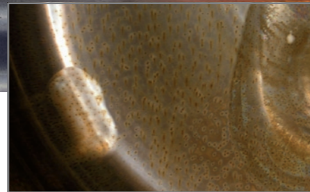
Abb. 2: Unterschiedliche Oberflächendefekte mit Korrosion durch Chloridionen
